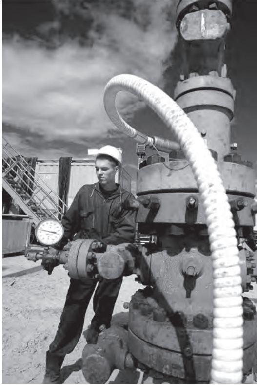
شكل ١-١: أحد العمال بحقل سبوريشيفسكويَا النَّفْطِي فِي سِيْبِرِيَا يَتَفَقَّد الضَّغْطَ عَلَى رَأْسِ إِحْدَى الْآبَارِ، الثَّلَاثَاء ٢٤ يُونِيُو ٢٠٠٣. (تصوير ديميتري بلياكوف/بلومبرج نيوز).
